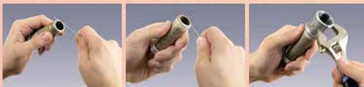
Может быть использована на влажной или незначительно загрязненной резьбе. Благодаря свойствам материалов при затяжке обеспечивается мгновенная надежная герметизация. При сборке возможна регулировка до 180°. Соединение не подвержено коррозии, устойчиво к вибрациям, перепадам температур в течение всего срока службы.
